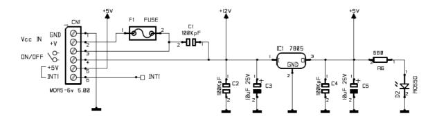
Lo schema elettrico è suddiviso in due grandi blocchi: l'alimentazione e la logica a microcontrollore. Quest'ultima opera su logica TTL a 5V. Un regolatore 7805 limita la tensione a 5 volt per l'alimentazione del micro. Esso è coadiuvato dalle rispettive capacità, atte ad eliminare eventuali oscillazioni. L'alimentazione è attestata dall'illuminazione di un diodo Led. Il microcontrollore utilizzato è un pin-compatibile del Pic 16F628.
